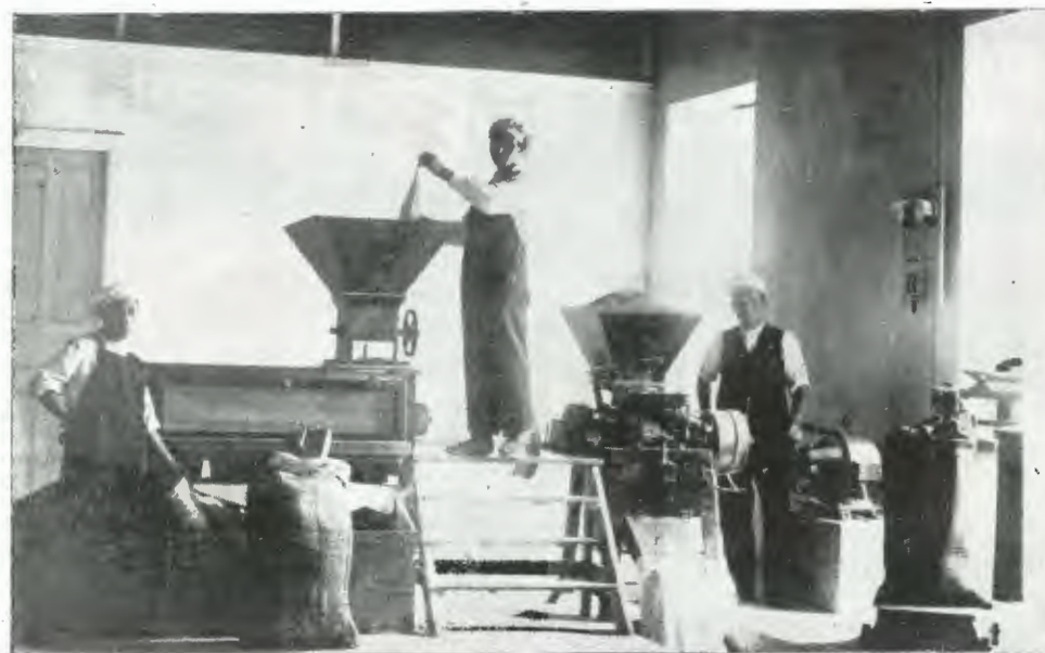
Molino "Krupp" de cilindros, con su cernidora de harina.
